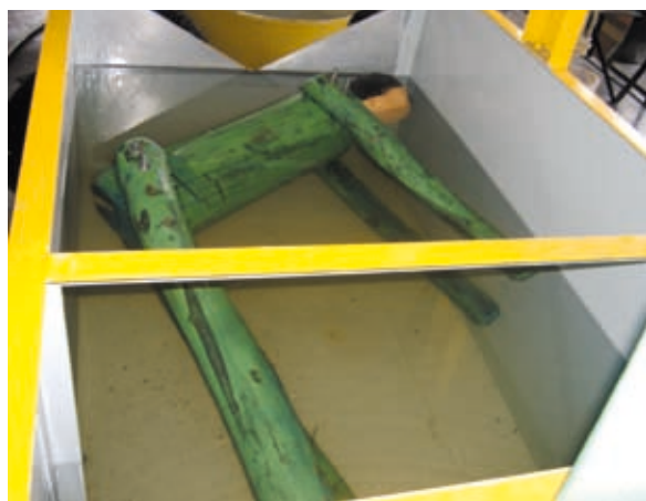
FIGURA 4. EJERCICIO DE CALIBRACIÓN DE LA DENSIDAD DEL OBJETO DE MADERA UTILIZADO COMO MODELO
